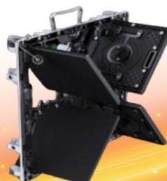
El módulo magnético admite el mantenimiento delantero y trasero
